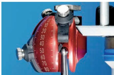
Abb. 47 Die Stützstiftkugel liegt an der Führungsbahn.
